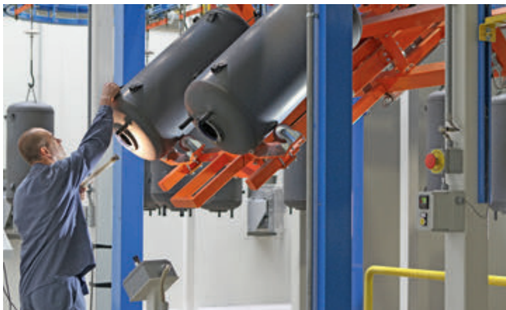
Vnitřní části bojlerů procházejí vizuální kontrolou před přidáním vnějšího pláště
