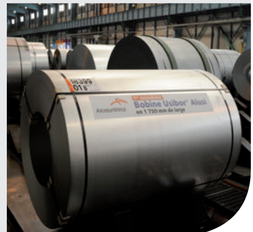
Das erste extrabreite Usibor® Alusi®-Coil, hergestellt im Dezember 2012
