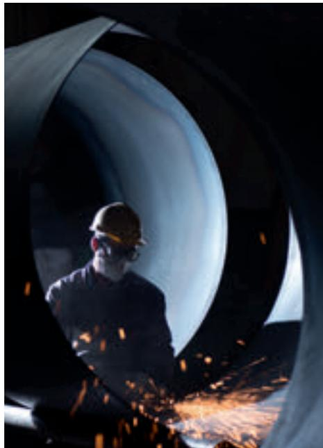
verwendet Isisan auch Dicken bis zu 70 mm bei Behältern, die Gase enthalten, die unter extrem hohem Druck stehen. „Dünnere (und dadurch leichtere) Druckbehälter sind ökonomischer, weil für ihre Herstellung weniger Ressourcen und Arbeit benötigt wird“, führt Murat Arslan aus. „Auch die Kosten sinken während der Nutzungsphase der Tanklebensdauer, da unsere Kunden aufgrund des geringeren Gewichts bei einer Fahrt mehr Gas transportieren können.“
