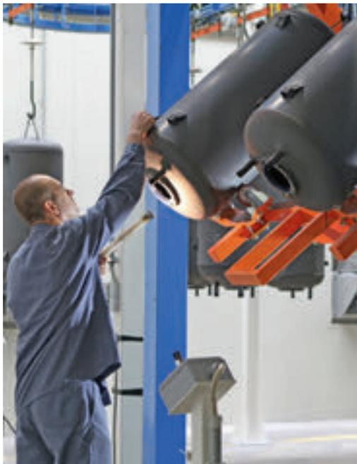
Sichtprüfung des Kessel-Inneren vor Montage des Außengehäuses
