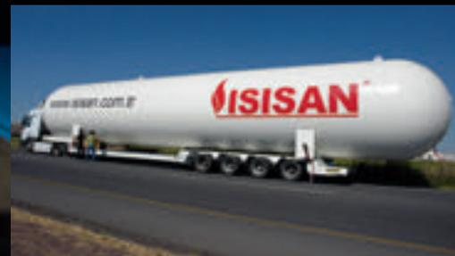
*Les réservoirs pour le transport de GPL et de GNL sont généralement fabriqués en acier et doivent répondre aux spécifications les plus sévères.*
