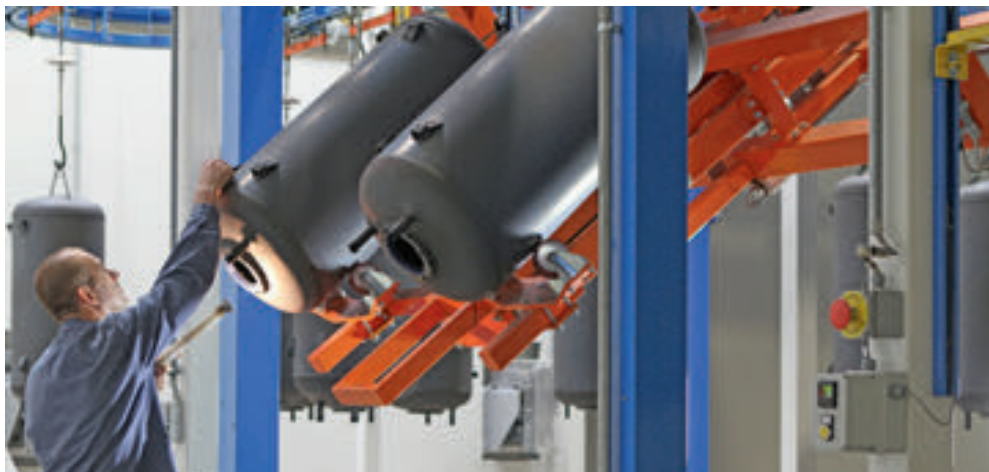
De binnenkant van de boiler ondergaat een visuele controle voordat de buitenmantel aangebracht wordt.
