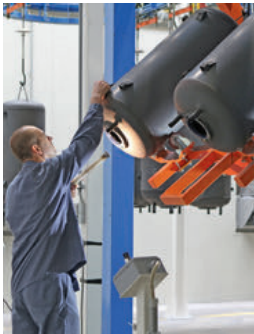
Przed instalacją obudowy, wewnętrzne elementy kotłów są poddawane kontroli
