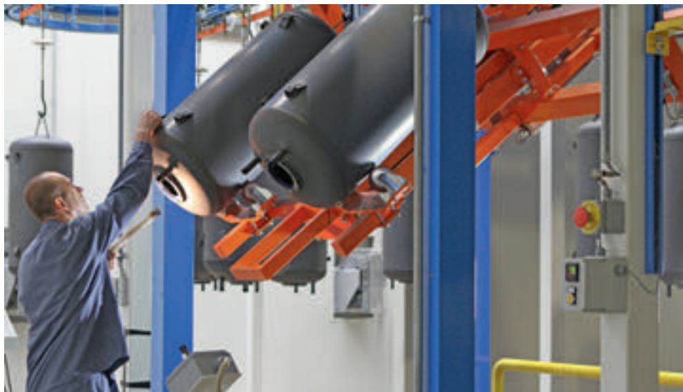
Rezervorul interior al boilerului este supus unui control vizual înainte de adăugarea carcasei exterioare
