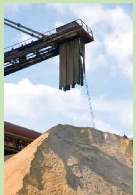
Od odpadu k energii: doprava granulované strusky přímo z vysokých pecí do cementárny zajišťuje nižší emise CO 2 a cement vysoké kvality.
