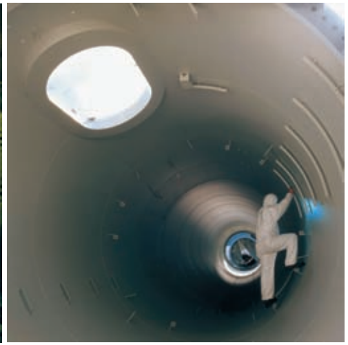
Montaje final de la torre de acero antes de su transporte hasta el emplazamiento
