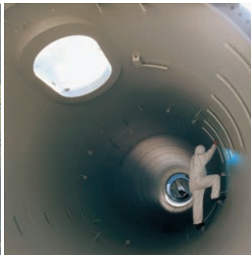
Assemblaggio finale della torre di una turbina prima del trasporto in loco
