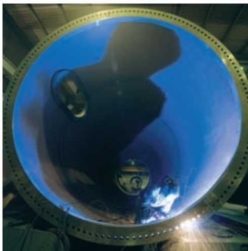
Assemblaggio finale della torre di una turbina prima del trasporto in loco
