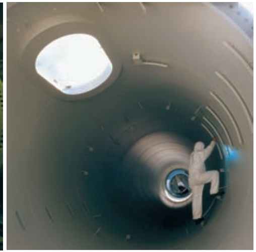
De laatste assemblagestappen worden uitgevoerd voordat de stalen mast naar de site getransporteerd wordt.
