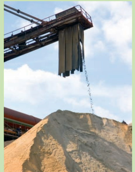
Van afval tot energie: transport van hoogovenslak rechtstreeks van de hoogoven naar de cementfabriek voor een lagere CO 2 -uitstoot en cement van hoge kwaliteit.
