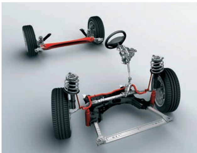
Montage voor de Renault Mégane III met een buisvormige twist-beam (in rood, op de achteras), schokdempers (in rood, vooraan), subframe voor de motor (in zwart, vooraan) en crashcomponent (zilverkleurig, vooraan)
