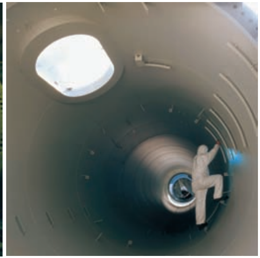
Finalny montaż stalowej wieży przed przewiezieniem na miejsce instalacji
