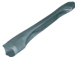
Rurowa belka skrętna tylnej osi Renault Mégane III
