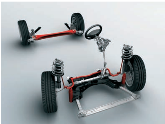
Podzespoły Renault Mégane III, m. in. rurowa belka skrętna (kolor czerwony, tylna oś), amortyzatory (kolor czerwony, przód pojazdu), przednie łoża (kolor czarny, przód pojazdu) i element energochłonny (kolor srebrny, przód pojazdu)
