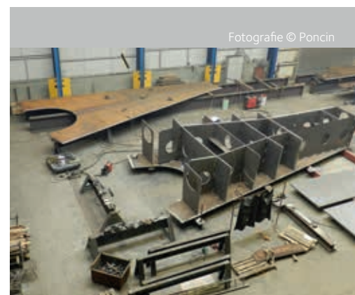
Výroba mostní konstrukce v dílnách závodu Poncin v Ocquier.
