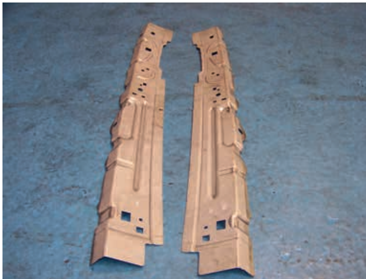
Prototyp za studena lisovaných sloupeků rámu předního skla po oříznutí a nalakování.
