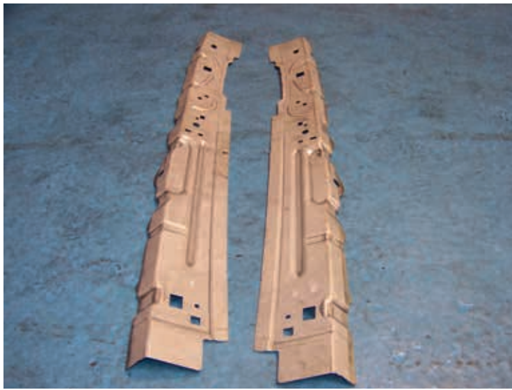
Prototypen von kaltumgeformten Frontscheiben-Säulen nach dem Schneiden und Lackieren.
