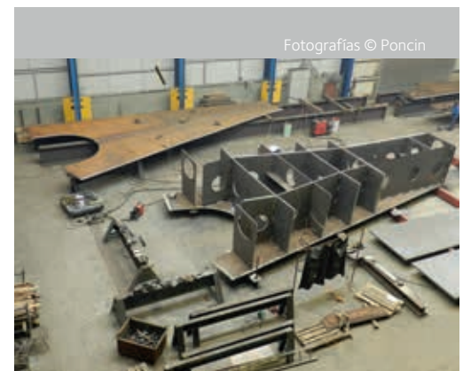
Fabricación de la estructura del puente en los talleres de Poncin en Ocquier.
