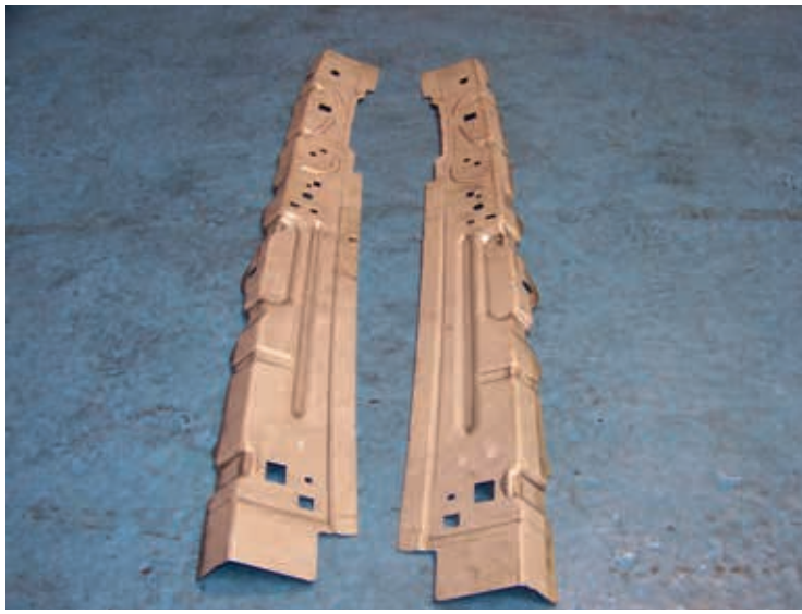
Prototipo de pilares de parabrisas estampados en frío después del corte y pintado.
