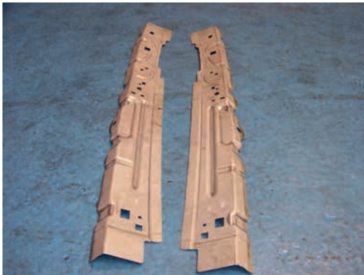
Prototype de montants de pare-brise emboutis à froid après découpe et peinture.
