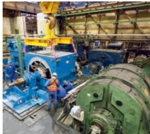
*Assemblaggio del nuovo motore sincrono per il treno di laminazione a freddo tandem per nastri (sinistra) e un vecchio motore a corrente continua (destra)*
