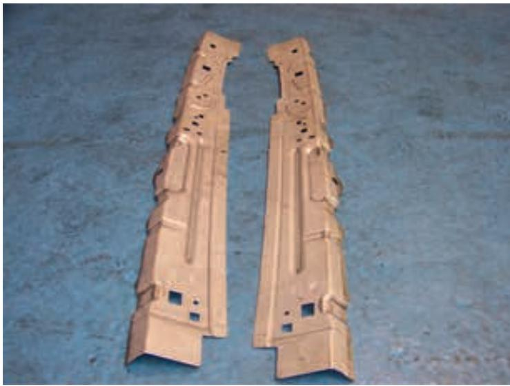
Prototipi di montanti di parabrezza stampati a freddo dopo il taglio e la verniciatura.
