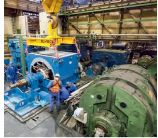
De nieuwe synchrone motor voor de tandemwalsgroep voor koudgewalste platen (links) naast een oude gelijkstroommotor (rechts)
