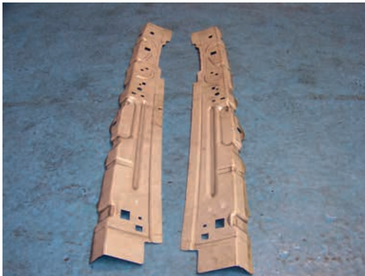
Prototype van koudvervormde raamstijlen die een knip- en lakproces ondergaan hebben.
