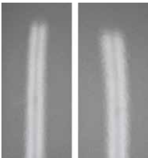
Diese Abbildung zeigt zwei Bleche. Das Muster links hat eine Ultragal®-Beschichtung. Beachten Sie die Spiegelung des Neonlichts. Die Wellenbildung auf dem Musterblech rechts (behandelt mit Extragal®) wird an der verzerrten Spiegelung sichtbar.
