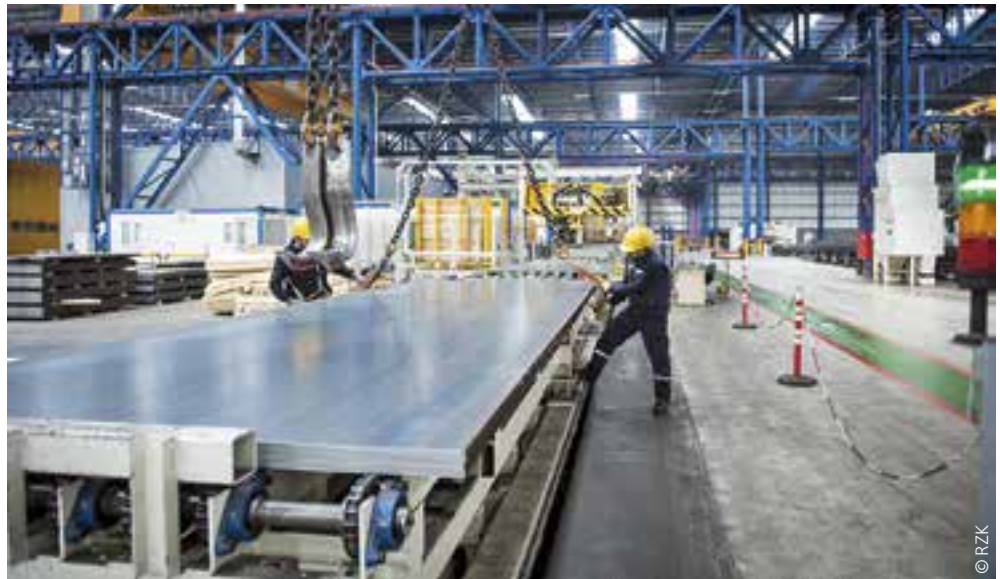
Das Unternehmen kann Blech bis zu einer Dicke von 1000 mm und einer Breite von 4000 mm verarbeiten, was ideal ist, um die Bedürfnisse der Schifffahrts- sowie Öl- und Gas-Unternehmen vor Ort zu bedienen.
