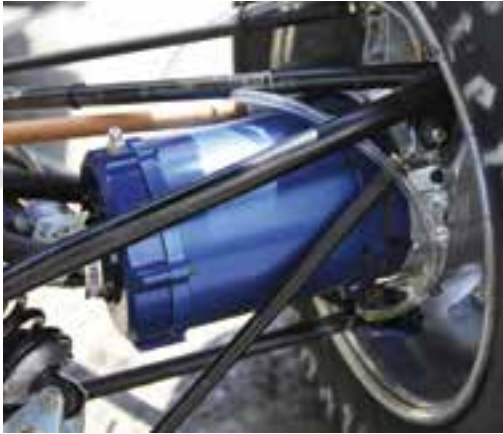
Jedes Rad wird von einem unabhängigen Elektromotor aus iCARE® Save Stahl angetrieben.
